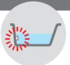
※ポンプが自動的に浴槽の水を循環させて、凍結を予防します。(ポンプが運転する音「ウーンという音」がします)
